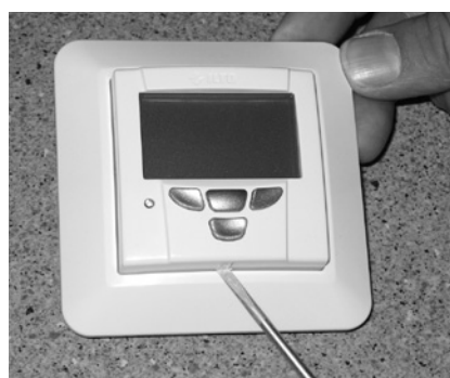
Demontering av frontplattan på en Premium kontrollpanel.
